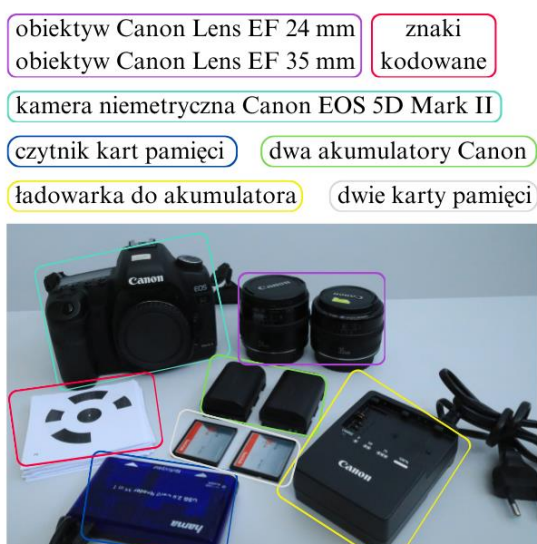
Rysunek 7.1. Aparatura badawcza wykorzystana do utworzenia bazy danych: sensor, akcesoria oraz specyfikacja kamery i dobrane parametry do przeprowadzenia pomiarów (źródło: opracowanie własne)
